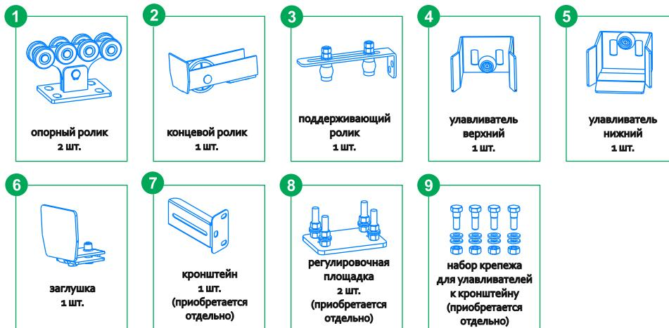
1. Опорный ролик выполнен из 8мм (основание и каретка) и 6мм стали(крепление основания к каретке).
