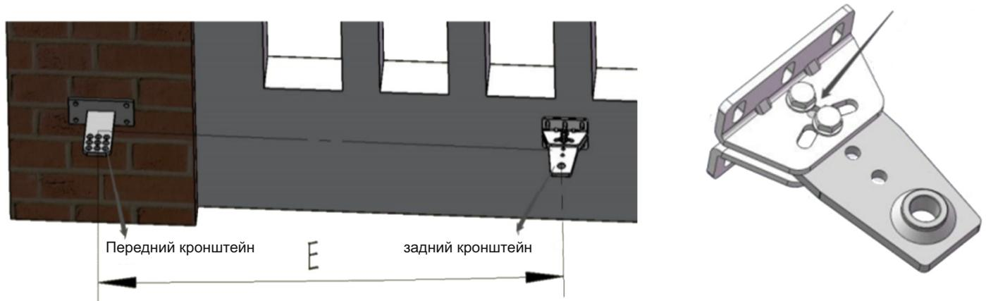
При закрытых воротах прикрепите крепежную пластину с передним кронштейном к створке ворот. Крепежная плата должна быть выровнена по горизонтали с задним кронштейном и необходимо соблюдать измерение Е.
