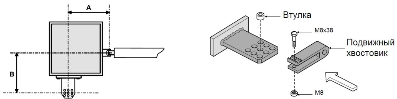
Прикрепите крепежную пластину и задний кронштейн (рис.1) к стойке, соблюдая измерения А и В, показанные на табл. 2, между штифтом петли и центральным отверстием в кронштейне. Задний кронштейн оснащен дополнительными отверстиями для изменения угла открывания ворот
