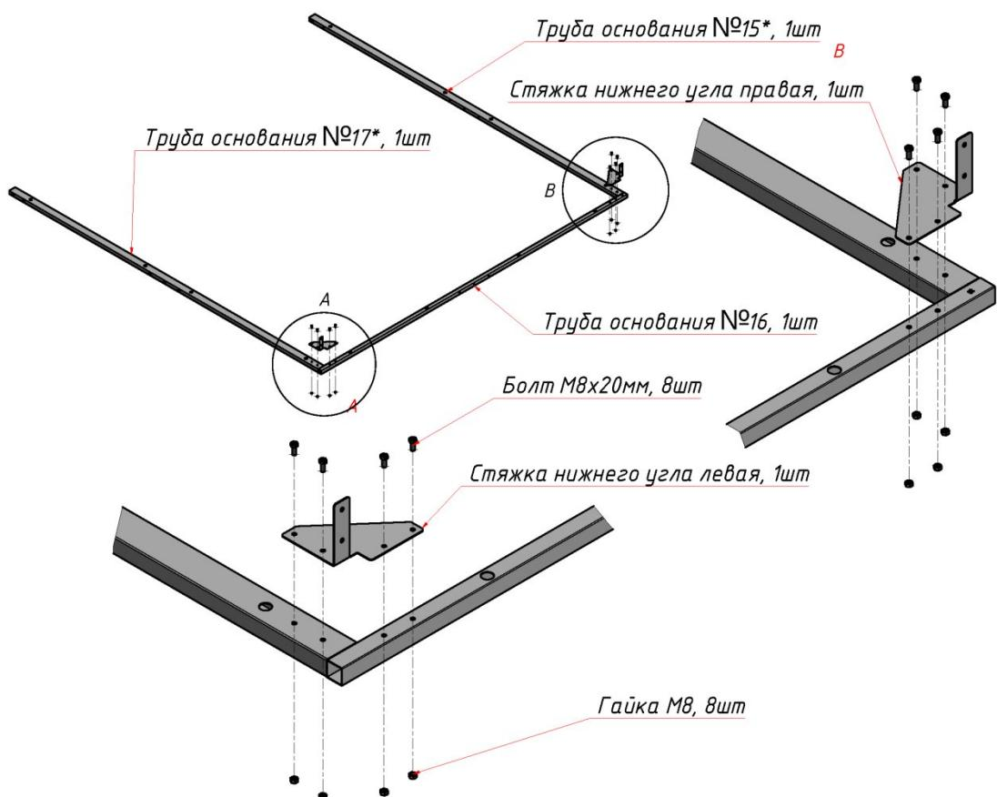
Для конструкции без промежуточных секций, труба №16 крепится к трубам №15, используемым в предыдущих шагах сборки, для остальных вариантов используются трубы №17 и №17-1, которые ни с чем не соединены.
