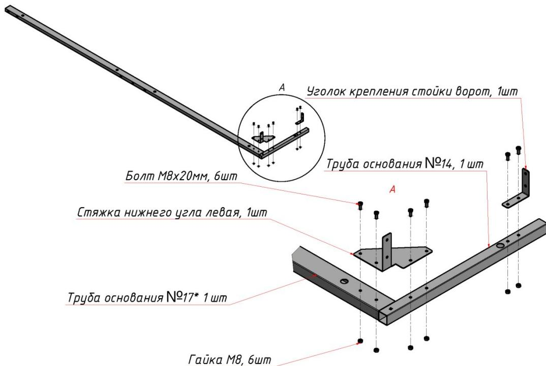
Сборка нижнего периметра осуществляется болтами M8x20мм и гайками M8.
