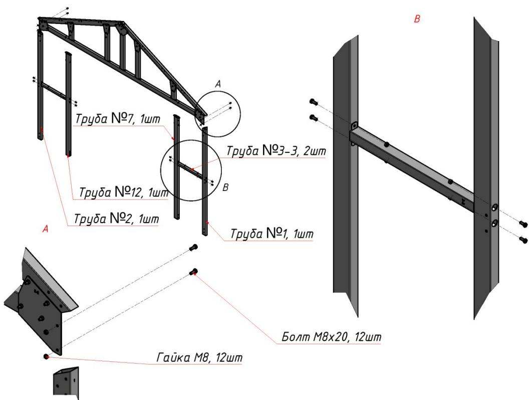
Угловые стойки к ферме крепятся на пластины, а стойки ворот прикручиваются болтами M8 к предустановленным вытяжным гайкам.
