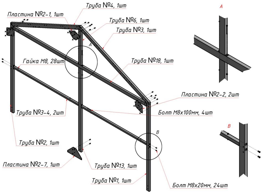
Задний портал собирается пластинаами с одной, противоположной большим отверстиям, стороне. Труба №13 к другим трубам крепится 4мя болтами M8x100мм и гайками, пластины – болтами M8x20мм и гайками.
