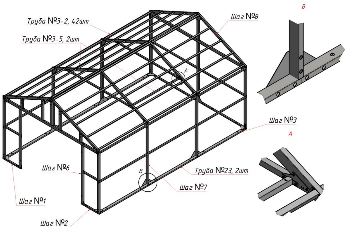
Финальная сборка каркаса отличается, в зависимости от количества секций, но принцип сборки один:
