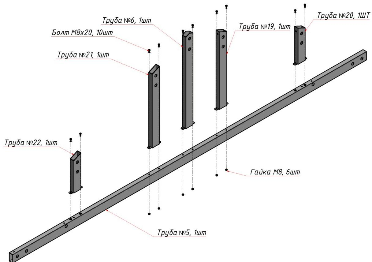
Сборка первого портала осуществляется с фермы, трубы №20 и №22 крепятся к предустановленным вытяжным гайкам болтами, остальные трубы собираются болтом и гайкой.
