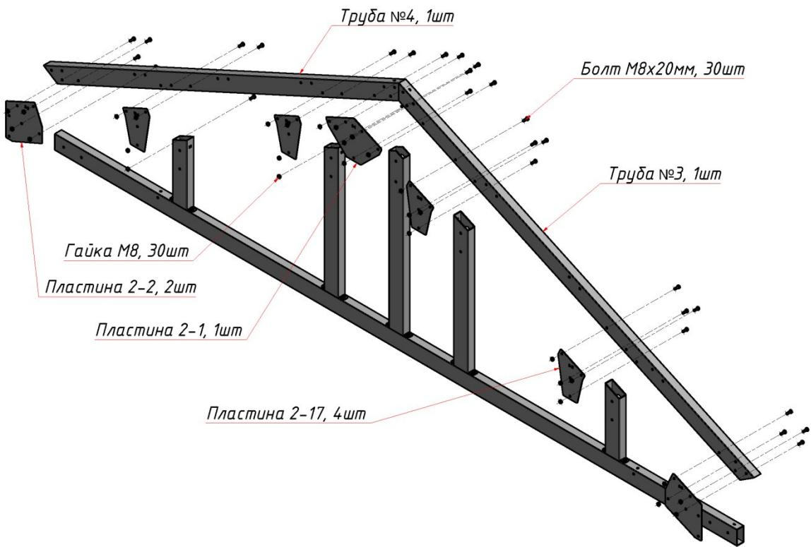
Стропила на переднюю ферму крепятся с помощью пластин с одной (внутренней) стороны, противоположной отверстиям, диаметром 25мм (большим) на болты M8x20мм и гайки.
